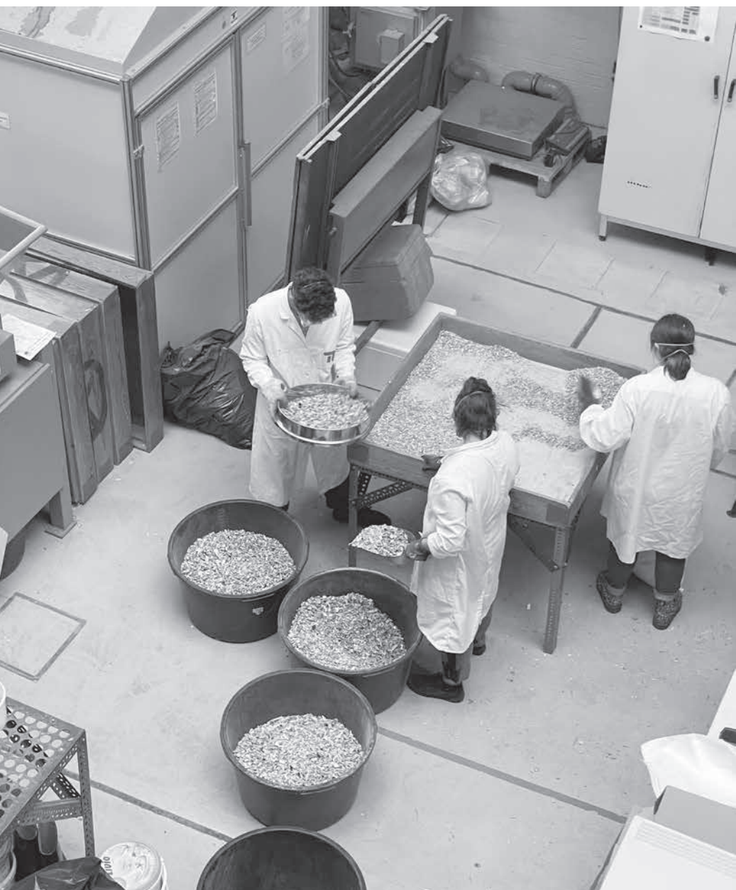
Resthölzer aus dem Haus der Materialisierung werden für die Pilzkultivierung geschreddert und gesiebt, TU Berlin, Fachgebiet Kreislaufwirtschaft und Recyclingtechnologie, Foto: Erik Göngrich, 2023
